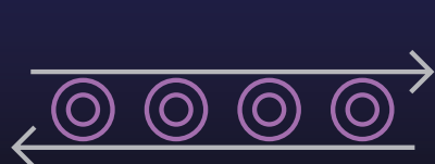
球状タングステンの回転効果による 摩擦抵抗の低減
