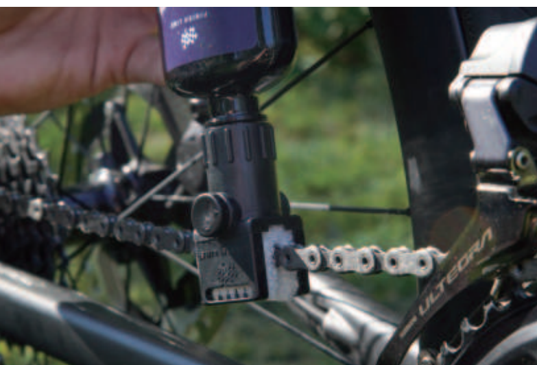
球状タングステンの回転効果による 摩擦抵抗の低減
