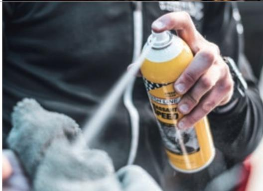
ディスクブレーキの場合は、「ディスクブレーキ クリーナー」をディスクローターやブレーキパッドに直接吹き付けて汚れを落とします。
